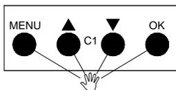
Presionando simultáneamente los 4 pulsadores durante 3s se produce el restablecimiento (reset) del interruptor a la configuración por defecto de fábrica.
