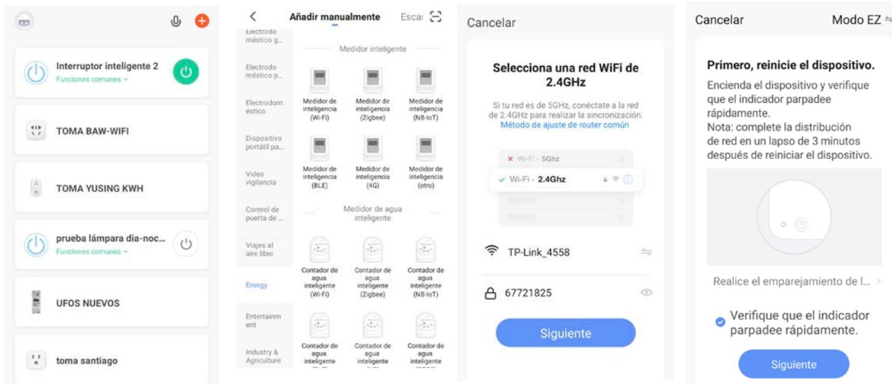
Si el equipo se conecta correctamente, puede realizar el Conexión/Desconexión de la carga, temporización, y la lectura de energía activa, corriente, tensión, potencia activa e historial de energía.
